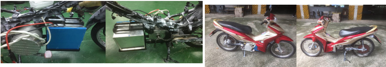
ภาพที่ 1 ชุดยึดมอเตอร์และชุดยึดแบตเตอรี่ที่ติดตั้งเข้ากับมอเตอร์ไซค์ไฟฟ้า
